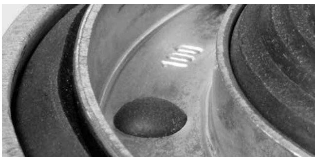
zintegrowany punkt kontroli poprawności montażu
