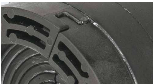
zazębiające się połączenie płyt dociskowych
